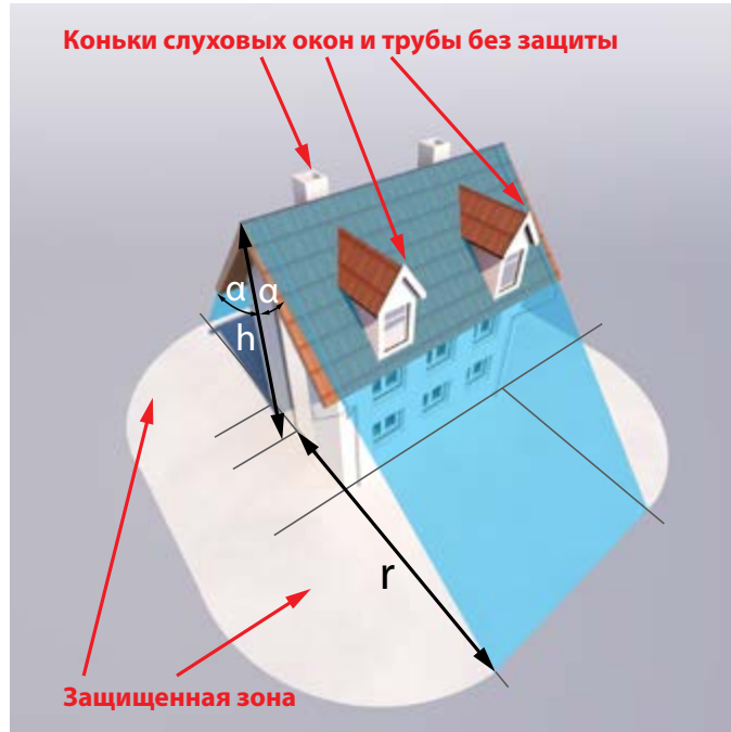
Рис. 2.3.5 - Зона защиты конькового молниеприемника
