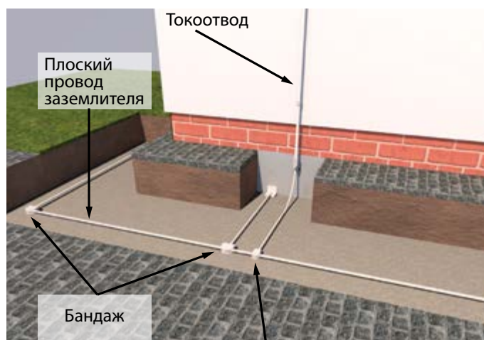
Рис. 2.10.5 – Кольцевой заземлитель типа В
