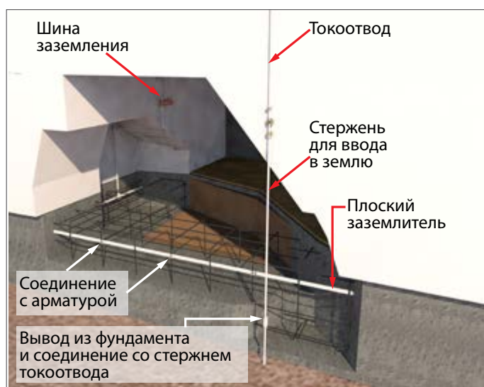
Рис. 2.10.6 – Фундаментный заземлитель типа В
