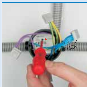
Активируйте кнопку программирования (красный СИД и подключенная нагрузка включатся)
