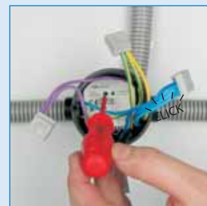
Повторно активируйте кнопку программирования для завершения процесса (красный СИД и нагрузка отключатся)
